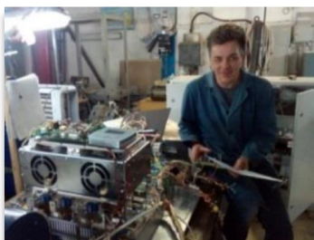
Изготовление блока силовой электроники
